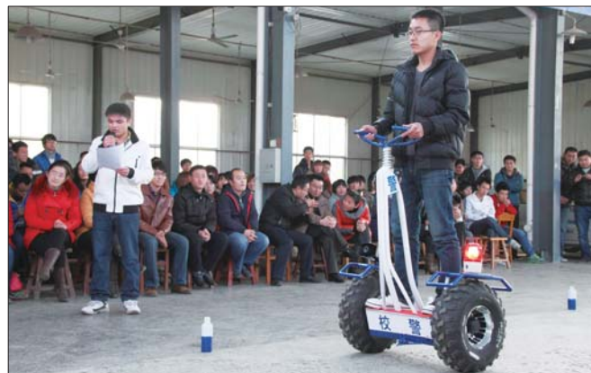
学院学生自行设计制造的“双电机同轴自平衡电动车”
