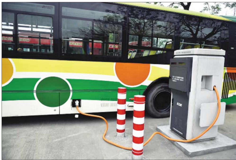
济宁城区规划建设公交充电站,加速公交车升级换代(资料图)。
