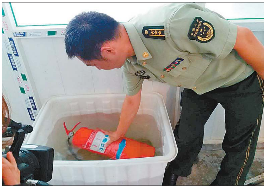
维修检测灭火器耐压性、气密性就靠一个水桶完成。本报记者 尉伟 摄
