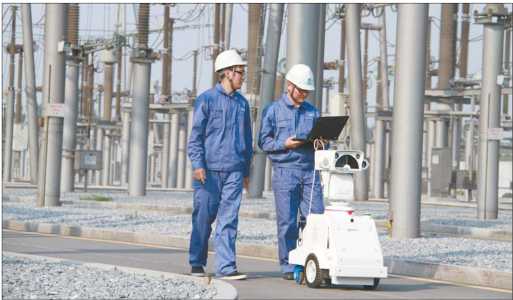
变电站智能巡检机器人调试。 本报记者 朱洪蕾 摄
