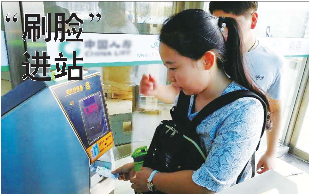
9月29日,淄博火车站进站口新增设了2台自动验票闸机,即人脸识别验票系统,工作人员正在进行安装调试,国庆节期间或可正式启用。旅客走近机器时,摄像头现场采集照片,与身份证芯片里的照片进行比对,如果票证信息相符,人脸与证件照比对通过,闸机将自动放行。自动进站验票更加安全、快速。
