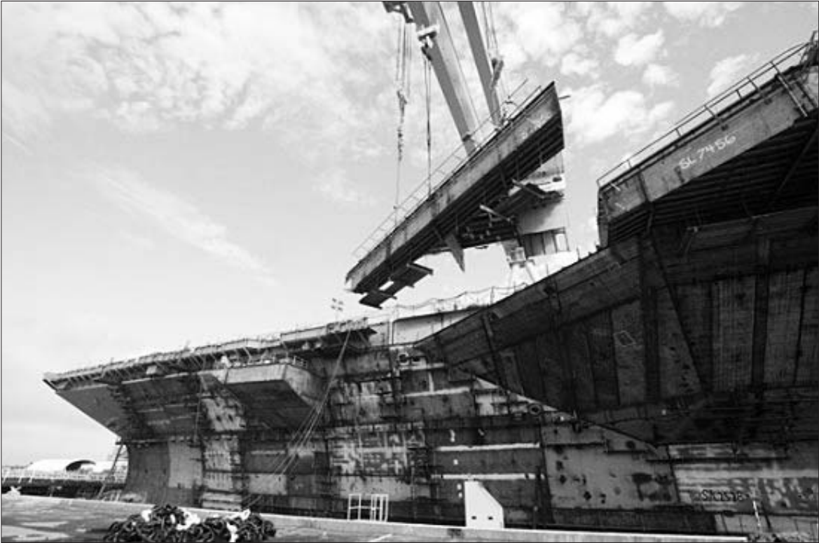
2013年5月8日，在弗吉尼亚州纽波特纽斯造船厂内,电磁弹射器单元正在被吊装进“福特”号航母。（资料片）
