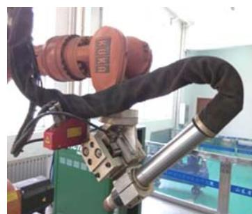
山东省智能机器人应用技术研究院成立于2015年1月10日,位于山东济宁邹城,是山东省首家工业机器人应用技术研究院,现有10套机器人工作站用于研发、实验已与9所高校、15家企业成为战略合作伙伴。该项目的背景是根据国际焊接工艺要求,当焊接母材厚度大于14mm时,必须经过坡口切割工序,方能满足焊接强度要求。该技术可以通过解析DXF文件,实现CAD文件(DXF格式)图元提取,并利用OpenGL将其复现到人机界面上,以便之后对图元信息进行变换。
