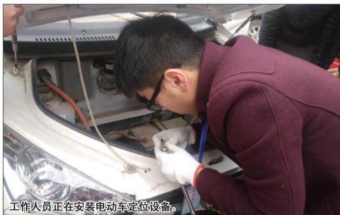
工作人员正在安装电动车定位设备。
