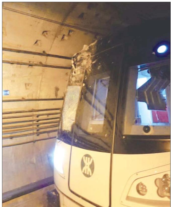
列车撞断击穿隧道的桩头,导致严重受损。
