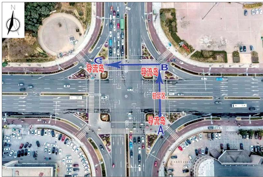
二次过街:如要从图中A到达C,需要先从A过街至B(按照信号灯指示),再由B过街至C(按照信号灯指示),此种通行方式称之为二次过街。
