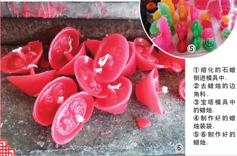
①熔化的石蜡倒进模具中。
