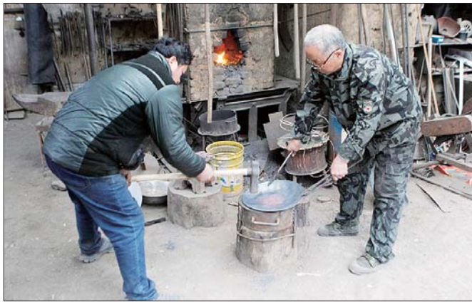
热锻是打出铁锅原型的必经之路。
