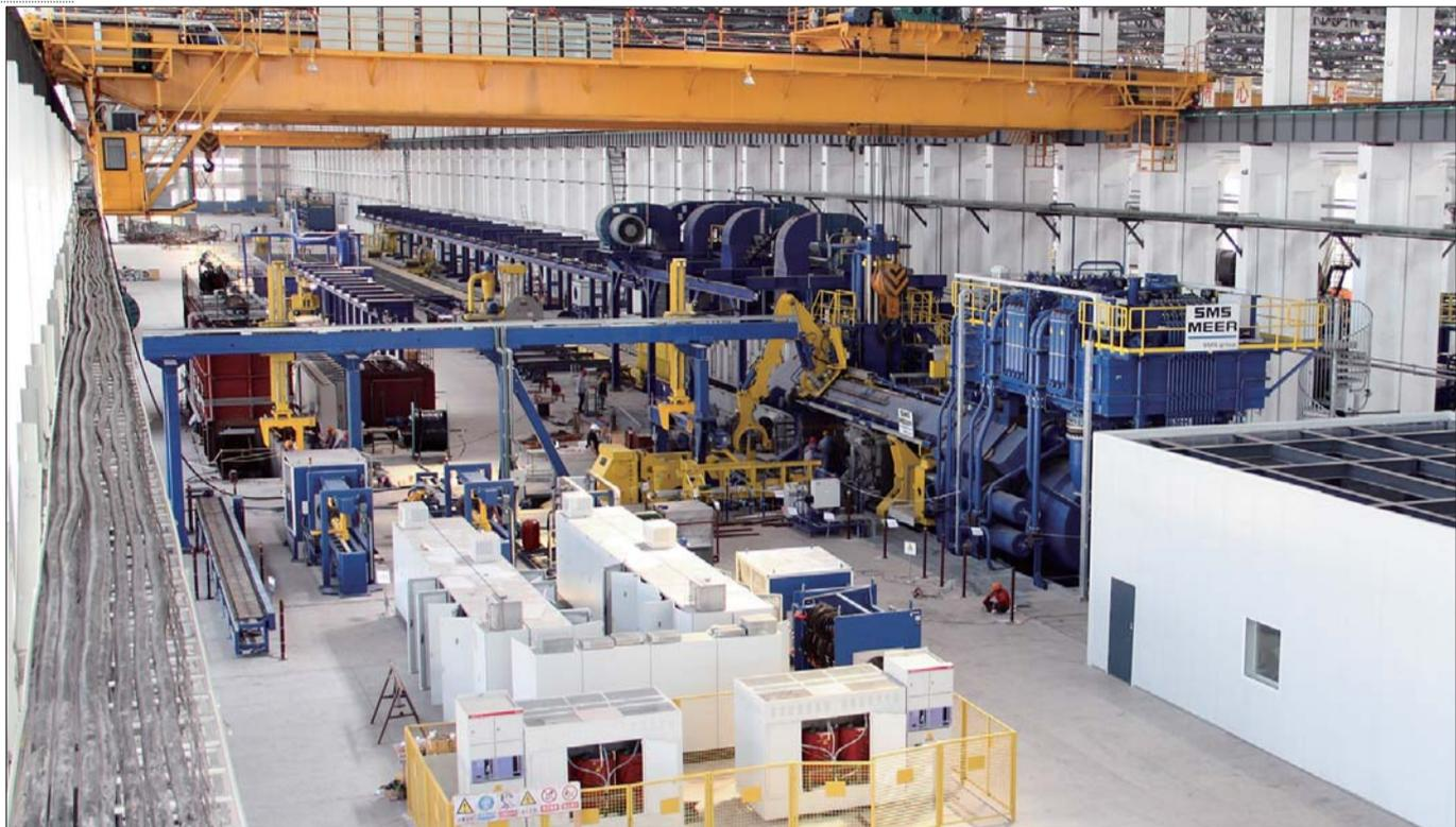
世界最大150MN挤压机生产线。
