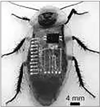
研究人员将人造神经连接到蟑螂腿上实现运动的控制。
