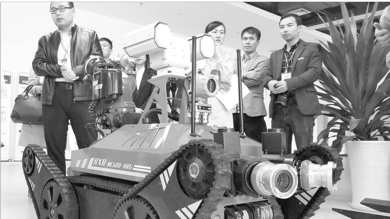
◀可以爬楼梯、可以靠近火场采集数据、可以喷水灭火,17日,在哈工大机器人(合肥)智能装备双创基地,技术人员启动了正在研发中的消防灭火机器人。
