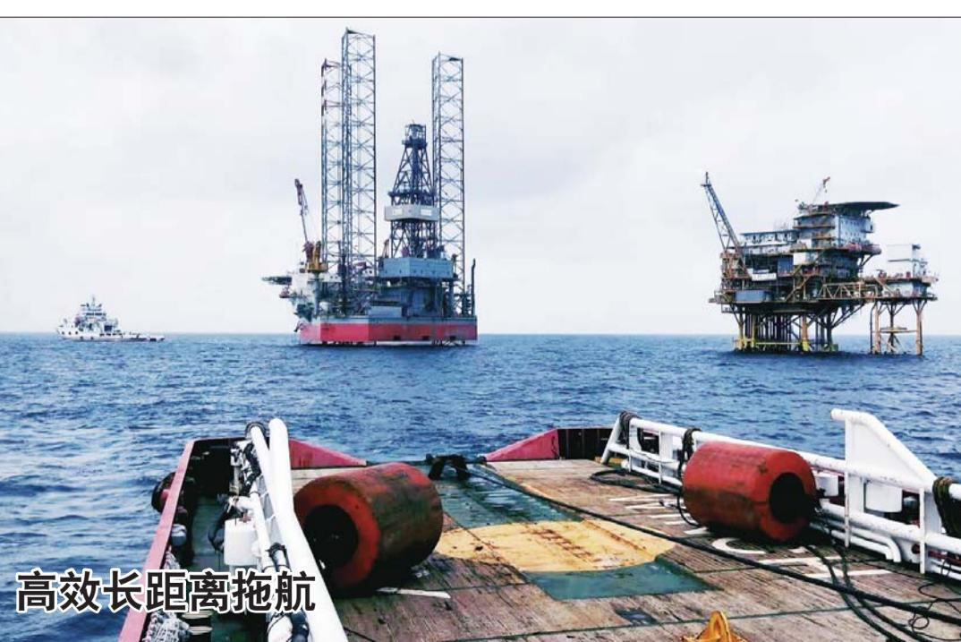
近日,胜利油田海洋石油船舶中心胜利292船历时272个小时、航行1100海里,顺利完成勘探七号由舟山到北部湾涠洲工区的拖航精就位作业。“根据途径海域海况复杂多变等生产实际,全船在全流程安全风险识别的基础上,对设备维护保养情况和运转情况进行全面排查,并对甲板拖带设备、助航设备以及救生设备进行详细试验。”船长韩海峰说,拖航小组在途径台湾海峡时,遭遇7级东北风,通过迅速调整船舶航行方向与航速等措施,确保拖航全过程安全高效。据了解,勘探七号平台型长70.36米,型宽76米,主要装备均为当前国际主流高端设备。
