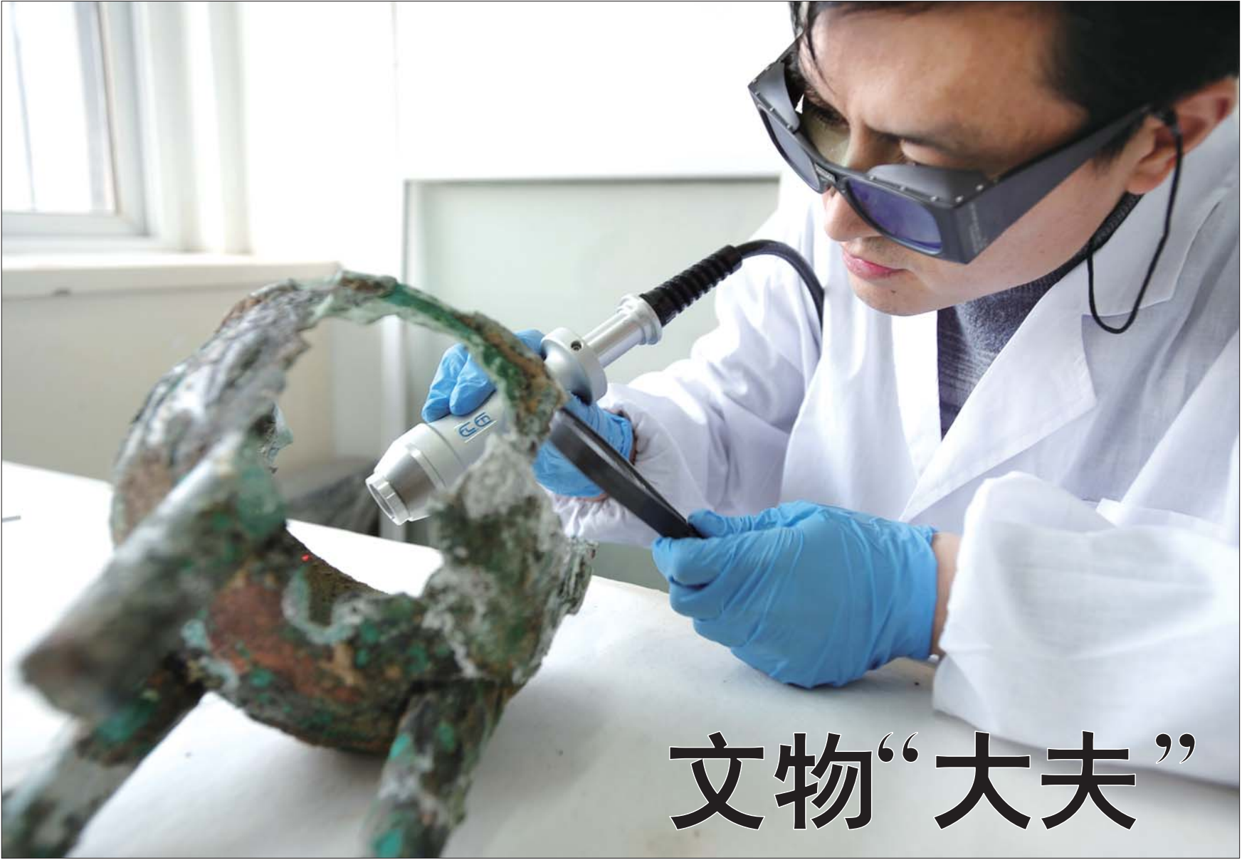
▲激光清洗机可以瞬间除去青铜器上的锈蚀物。
