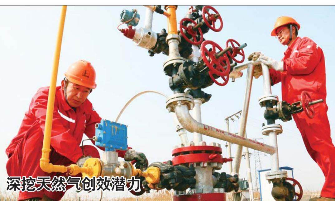
5月19日，胜利油田现河采油厂史南采油管理区员工在电泵井梁60-24井现场，调试套管气回收装置。今年以来，现河采油厂在推动主业高质量发展进程中，把深挖天然气潜力作为重点工作，并制定了增产556万方、创效1000万元的年度目标。为此，该厂牢固树立“一方气也是效益”的理念，实施四类套管气治理技术，并自主研制了星旋泵式、电动活塞式、射流式等多种套管气回收装置，在9个区域内集中高效收气，确保套管气全面回收。据统计，一季度，该厂完成天然气商品量280.63万方，同比上升77.18万方。
