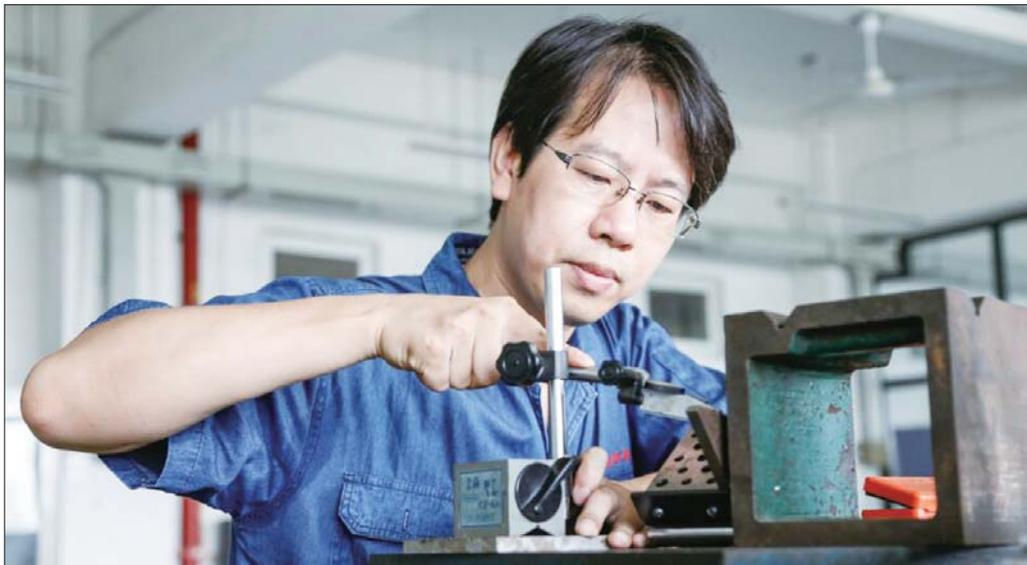
▲孟庆站利用杠杆百分表和正弦规对钳工技能大赛的考件进行精密测量。
