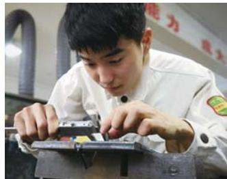
张富斌正在测量焊接完成的工件。
