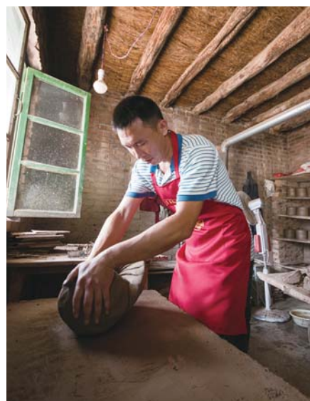
揉泥,将胶泥完全揉匀,胶泥内不允许出现气泡
