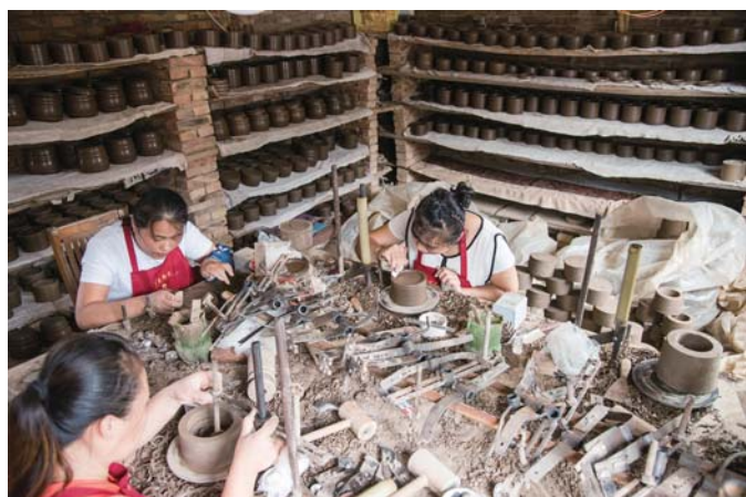
晾成半干的蚰蚰罐进行定型和压光
