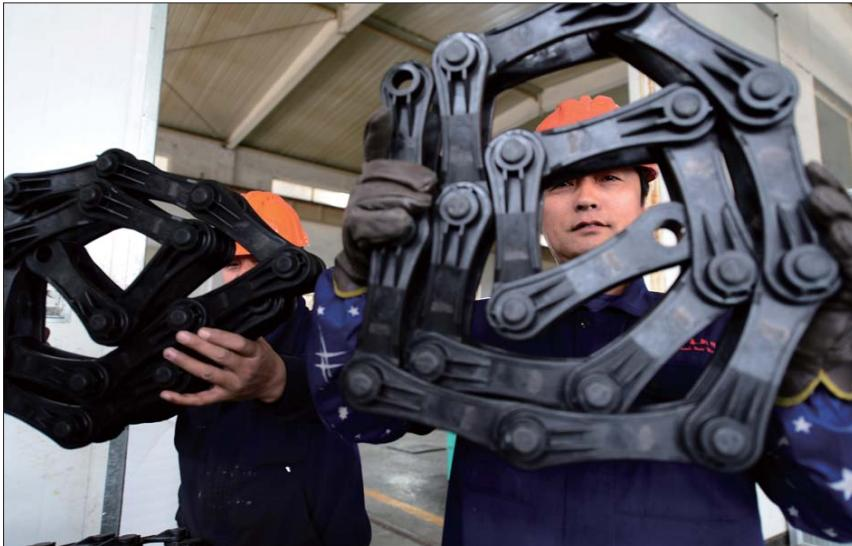
2019年12月15日,石岛管理区丰泰新材料产业车间,工人正在用高分子尼龙环保材料做机械链条。
