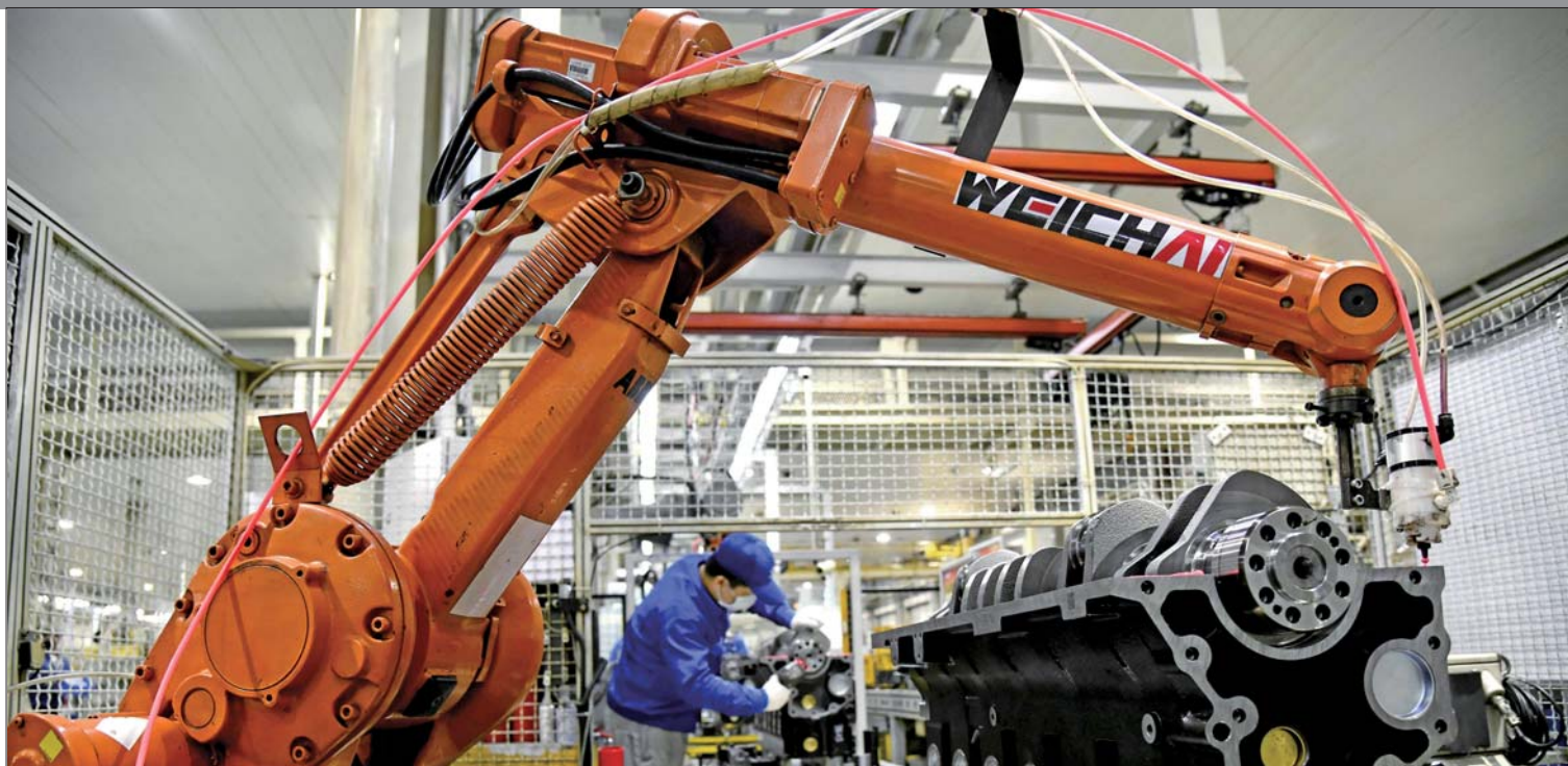
山东潍柴稳步有序复工,图为潍柴集团一号工厂总装车间,工人在流水线上装配发动机。 新华社发
