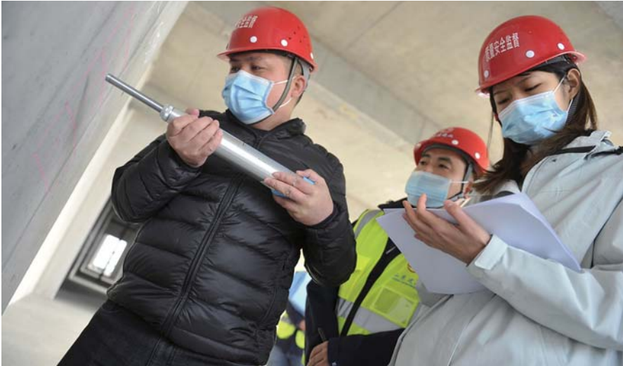
济南市工程质量与安全中心工作人员正在对工程主体混凝土强度进行检测。
