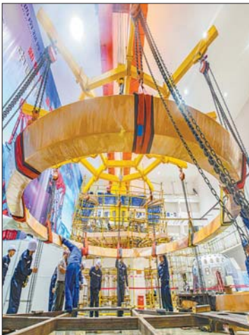
中核集团核工业西南物理研究院的工作人员在安装调试中国环流器二号M装置时起吊线圈(2019年9月16日摄)。新华社发
