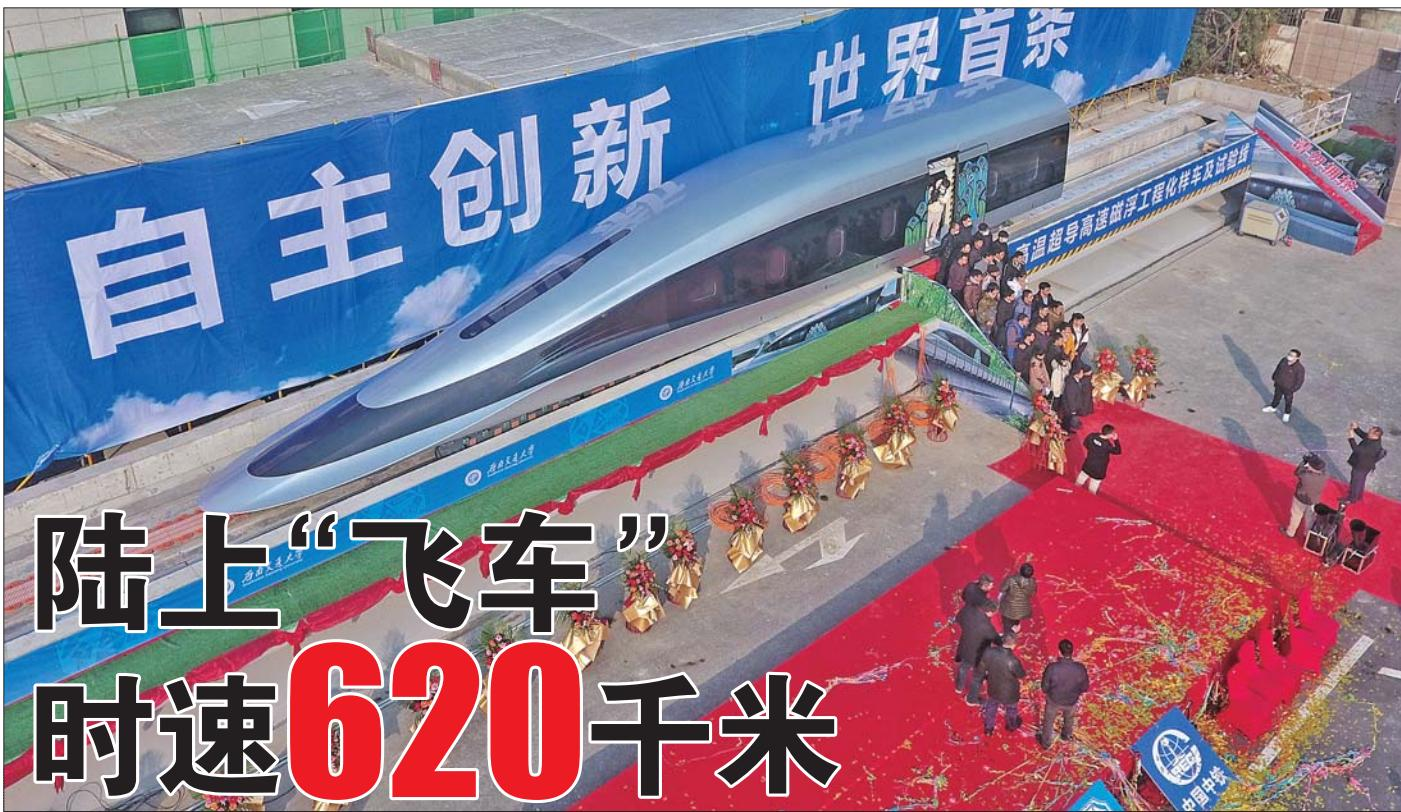
1月13日上午,一节银黑相间的工程化样车在位于成都的试验线上缓缓行驶。这是由我国自主研发设计、自主制造的世界首台高温超导高速磁浮工程化样车及试验线正式启用,设计时速620千米,标志着我国高温超导高速磁浮工程化研究实现从无到有的突破。
