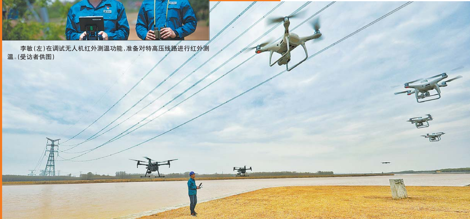
李敏一人同时控制6架无人机，对特高压线路进行全覆盖智能巡检。(受访者供图)
