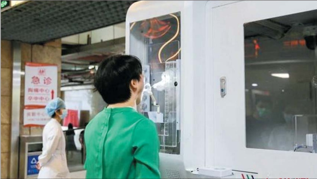
智能咽拭子机器人可满足核酸规模化采集需要。 呼吸疾病国家重点实验室供图
