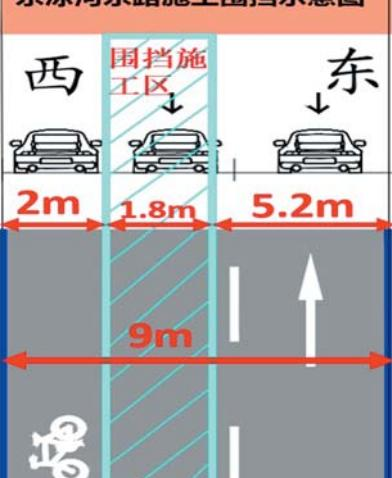
济南热力集团有限公司于2021年8月27日—9月25日,在东泺河东路(水屯北路—北园大街)进行热力管道施工,工期30天。整体采用全天封闭围挡施工,围挡1.8米机动车道进行全封闭施工;局部路口、横穿、分支施工均采用夜间施工时段,施工时间节点为22:00—次日06:00,白天施工区域恢复通行。请过往车辆注意绕行,施工期间给周边居民带来不便,敬请谅解。施工位置及围挡横断面布局如下图和右图所示。
