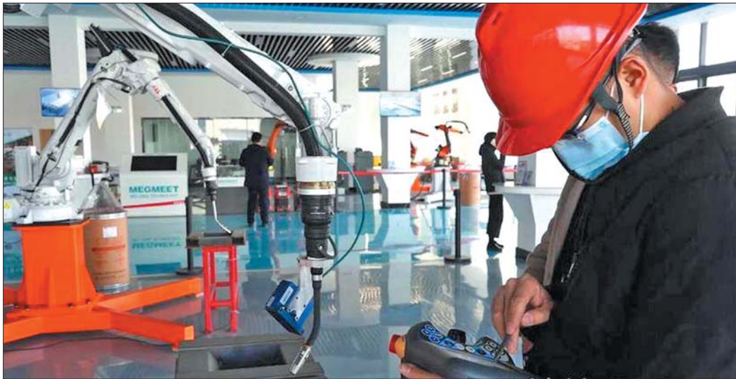
工人为焊接机器人调整参数。
