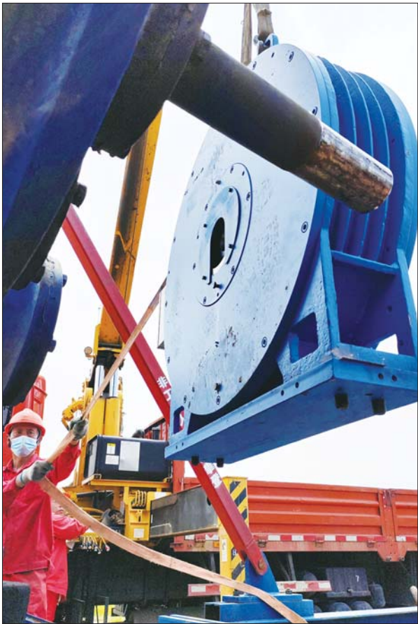
员工在滨169斜9井场,更换永磁低速同步电动机。
