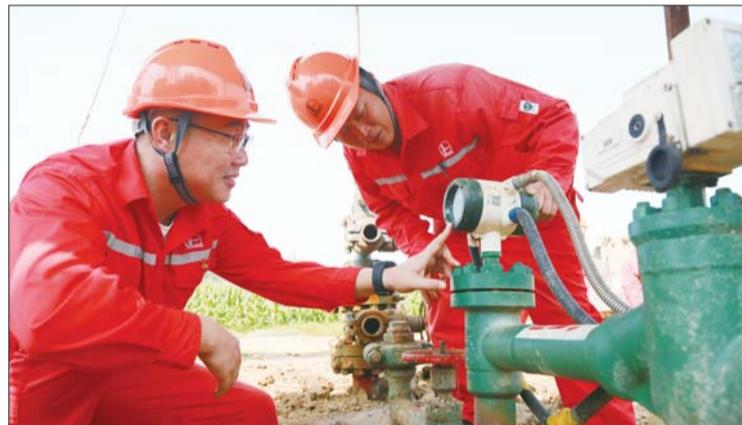
近日,在胜利油田鲁明公司济北采油管理区曲104-斜721井生产现场,安全生产指挥中心副经理李勇和李德海正在调试掺水流程水量。据了解,为保证冬季油井升温正常,这个管理区提前对所有油井进行摸排,对冬季回压高、升温难的油井加装升温设备,对需要进行掺水的油井进行调试,查漏补缺、补齐短板,确保冬季时设备、管线、流程运行正常,为年度收官打下坚实基础。
