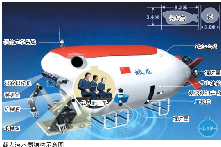
载人潜水器结构示意图
