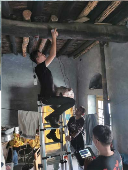
工作人员对历史建筑的木构件进行检测。
