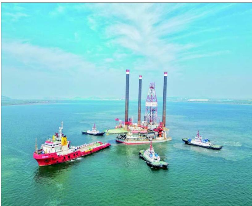
近日，胜利油田海洋石油船舶中心历时40多个小时不间断航行，成功完成胜利十号平台长距离拖航移就位作业。据了解，拖航初期，便遇到平台离井难度较大等问题，需要严格把握好离井速度，控制桩腿起落速度。拖航指挥经过精准核算，加强与主拖轮密切配合，完成离井作业，安全平稳穿越渤海风电场。抵达船厂后，拖航小组利用主拖轮和三条辅助拖轮帮助平台进坞。油田生产黄金季以来，海洋石油船舶中心科学安排生产船舶，共完成海上大型施工二十余次。
