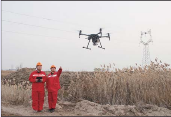
工作人员在220千伏万九线利用无人机进行线路精巡,确保路线安全稳定运行。
