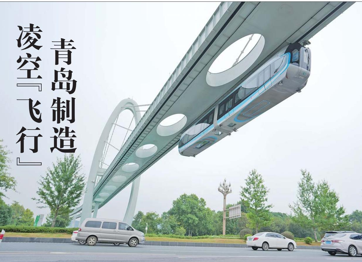
9月26日,中车四方股份公司自主研发的我国首列商用悬挂式单轨列车“光谷光子号”在武汉光谷空轨旅游线投入载客运营,标志着我国空轨列车首次实现商用。作为一种新型立体交通工具,该列车的轨道由钢结构立柱支撑在空中,车体悬挂于轨道梁下方,在半空中行驶,有“空中列车”之称,极具科幻感。记者 赵波 通讯员 邓旺强 摄影报道
