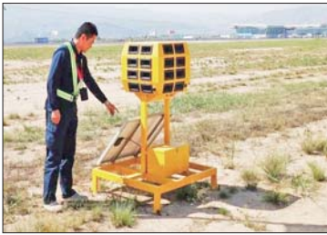
西宁曹家堡国际机场的太阳能声波驱鸟器。
