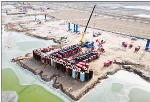
近日,在胜利油田孤东采油厂孤东281斜更11井场,14台压裂车、2台混砂车组成的压裂车组正在进行压裂试工。
