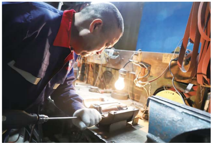
工人正手持砂轮精心打磨抛光玻璃酒瓶模具。 崔如坤 摄
