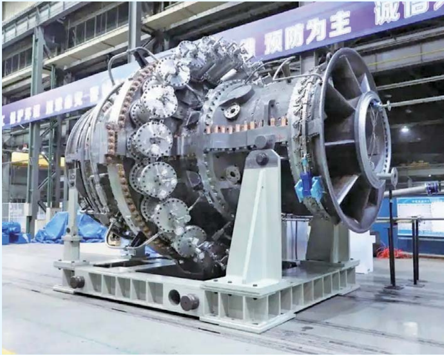
“太行110”是我国自主研发的国内功率最大的重型燃气轮机。
