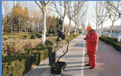
运维人员使用激光炮清除线路异物。
