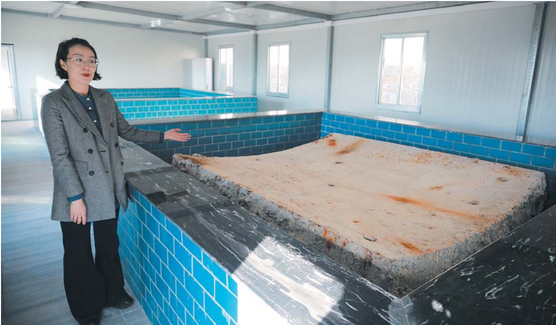
刘晔介绍定远舰“铁甲”脱盐保护过程。
