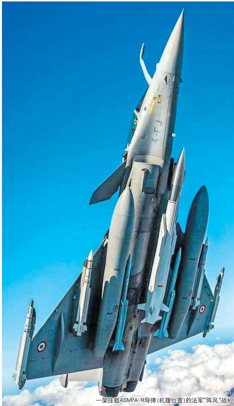
一架挂载ASMPA-R导弹(机腹位置)的法军“阵风”战机
