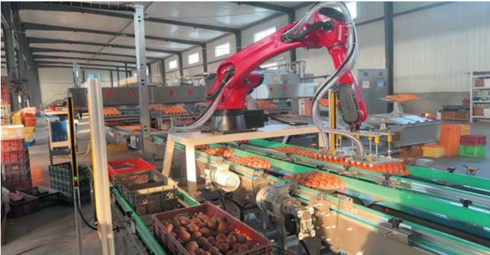
长田实业的智能装箱设备—机械臂。
