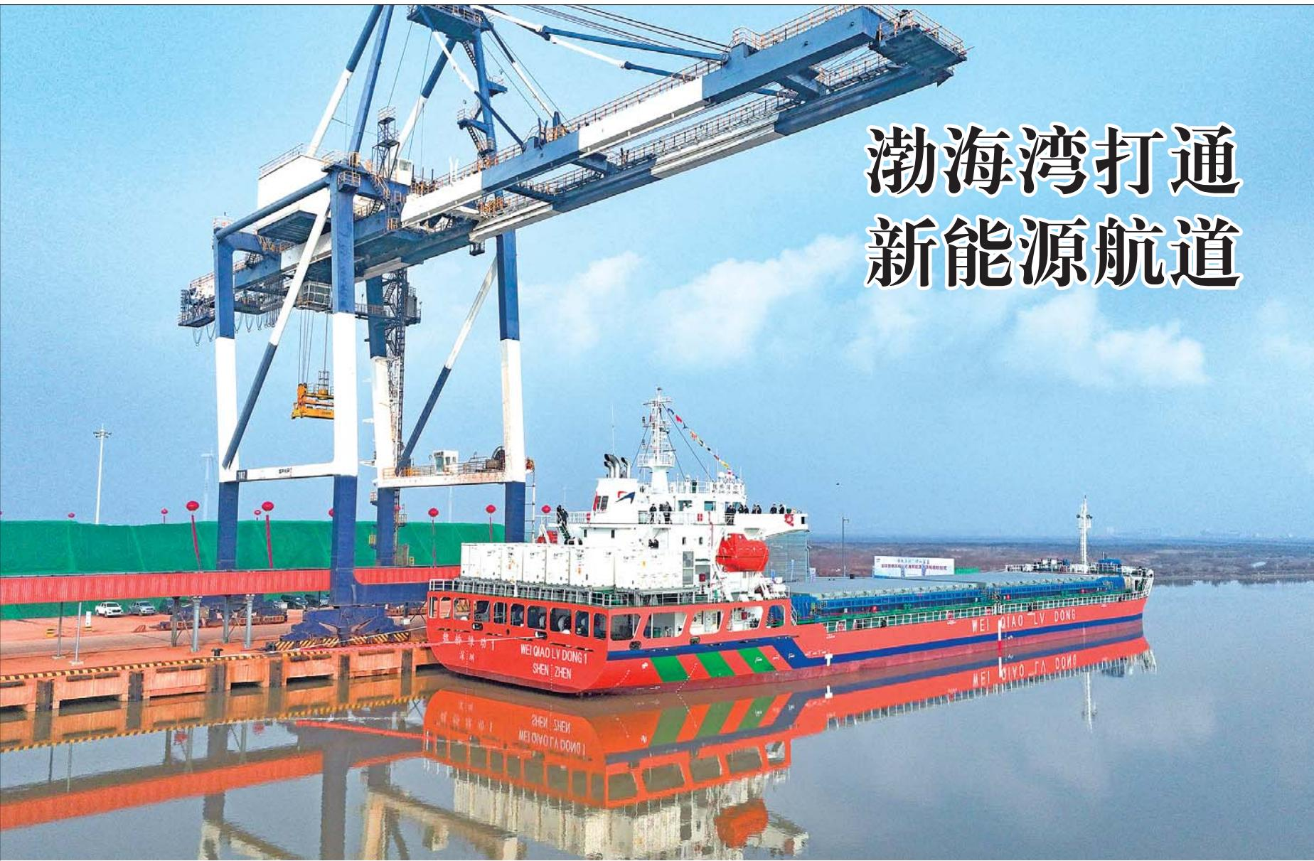
12月29日,满载铝矾土矿的万吨级近海航区新能源散货船“魏桥绿动1”货轮停靠在滨州市无棣创业码头,等待卸货(无人机照片)。“魏桥绿动1”轮12月27日从山东港口烟台港装满铝矾土,于12月28日抵达无棣创业码头,标志着烟台至滨州渤海湾首个新能源航运物流通道正式打通。“魏桥绿动1”货轮采用并联油电混合驱动技术,在船尾甲板配装8个集装箱式锂电池组,最大纯电续航可达150海里,进出港期间进行纯电驱动,可实现港口区域零排放。
