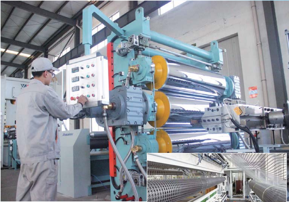
▲双轴取向高强度土工格栅生产线正在运转。
