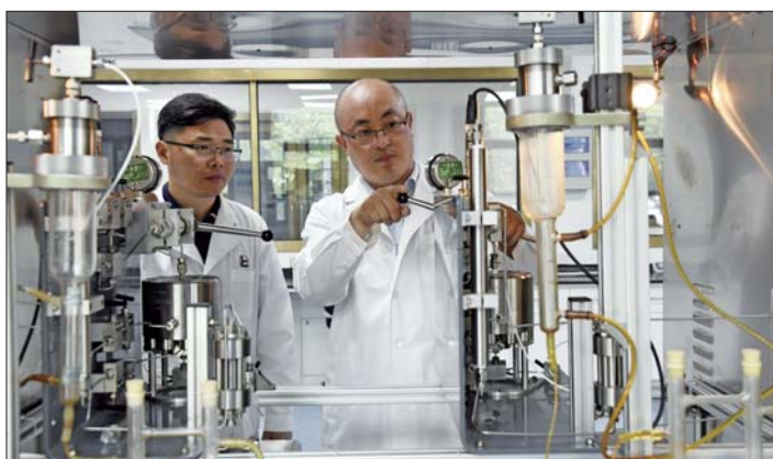
胜利油田CCUS攻关团队开展二氧化碳驱油与封存物理模拟实验。 通讯员 朱克民 摄
