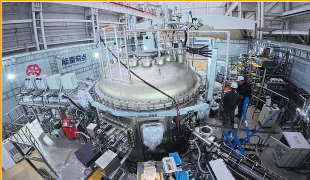
3月31日拍摄的全高温超导托卡马克装置“洪荒70”。 新华社发
