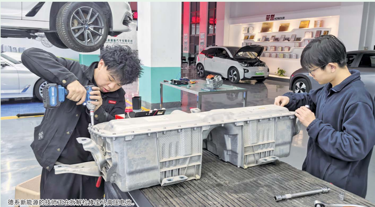
德系新能源的技师正在拆解检修宝马高压电池。
